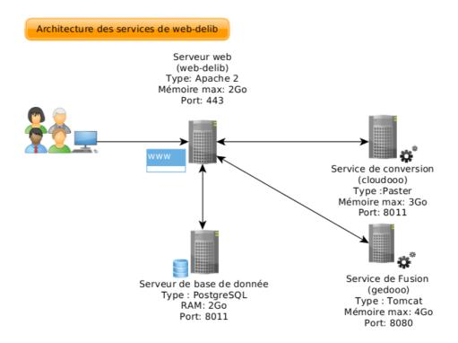
web-delib est utilisé dans un réseau local, mais peut être utilisé via le réseau internet sachant que la qualité de service dépendra du flux de donnée à traiter.
